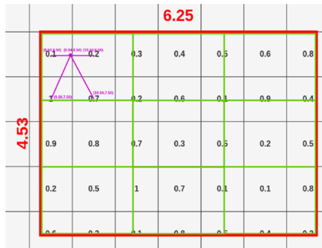
10. ábra RoI Align kvantálás nélkül, bilineáris interpolációval
